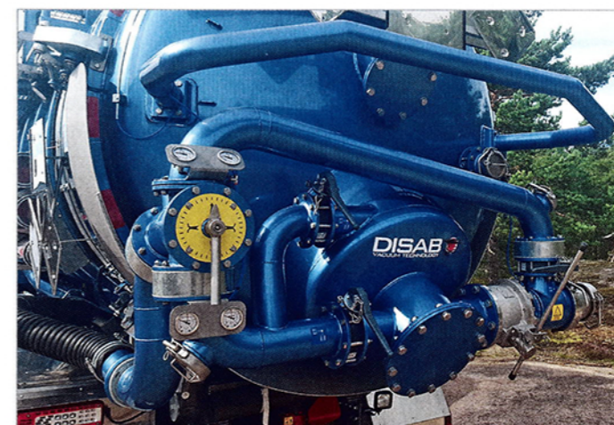
Kaikki sulkuventtiilit ovat säiliön ohella valmistettu haponkestävästä AISI 316 -teräksestä. Letkut ja putket liitetään toisiinsa Disabin itse kehittämällä Disaflow-liittimillä. Ne ovat kestäviä ja tiiviitä.
